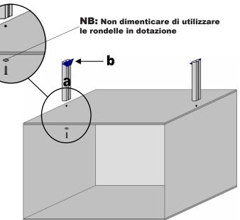
Forare il piano della cassettiera con una punta Ø10 rispettando le misure indicate (856 mm e 140 mm), posizionando sotto il piano stesso, durante la foratura, un legno in modo da non danneggiare la parte interna.
