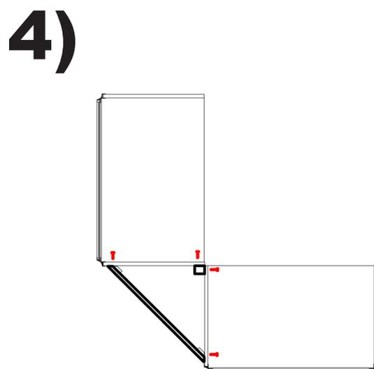
Inserire e fissare il pannello ai banchi inserendo le viti dall'interno del banco. Posizionare e fissare i top dall'interno del banco con le viti 3,5 x 35
