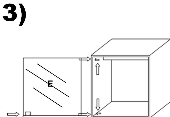
Inserire a pressione le cerniere dei vetri nei fori della base e del cielo, successivamente infilare ANTA in VETRO (E) nelle fessure delle cerniere stringendo le viti, nello stesso modo inserire la SERRATURA tenendola a distanza di circa cm 2 dall'angolo fino a combaciare la fessura sottostante ed avvitarla.
