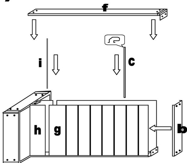
Inserire i pannelli(g) e infilare nelle fresate i copriguida(c) nel verso indicato dalla figura. Immettere tra base e pannello(g) il pannello(h) con annesso giunto(i) precedentemente attaccato. Applicare ai 2 montanti(f) gli angolari ed infine unire il montante(b) rimanente all'insieme.
