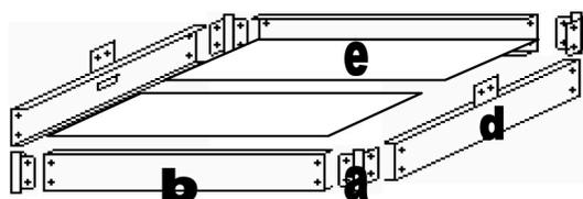
Congiungere i 4 angolari (con foro filettato(a)) con i montanti con piastra(d) e senza(b), posizionando i pannelli lisci(e) come da figura. Al termine dell'operazione avvitare i piedini.
