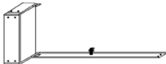
Congiungere i 4 angolari (con foro filettato (a)) con i montanti con piastra (d) e senza (b), posizionando i pannelli lisci (e) come da figura. Al termine dell'operazione avvitare i piedini.
