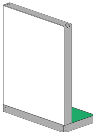
Inserire i pannelli (g) ed infilare nelle fresate i copriguida (c) nel verso indicato dalla figura. Immettere tra base e pannello (g) il pannello (h) con annesso giunto (i) precedentemente attaccato. Applicare ai 2 montanti (f) gli angolari ed infine unire il montante (b) rimanente all'insieme.
