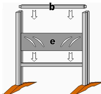
Montare i piedi(d) ai piantoni(a) avvalendosi delle viti M10 e, successivamente, congiungere le due parti premontate alla barra separatrice(b) con viti e divaricatori come nel riquadro in figura 1.
